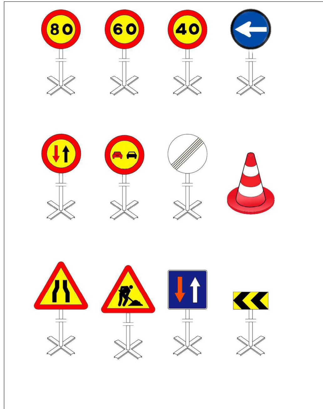
Equip estàndard Senyalització provisional d'obres per carretera convencional Equip de senyalització provisional
