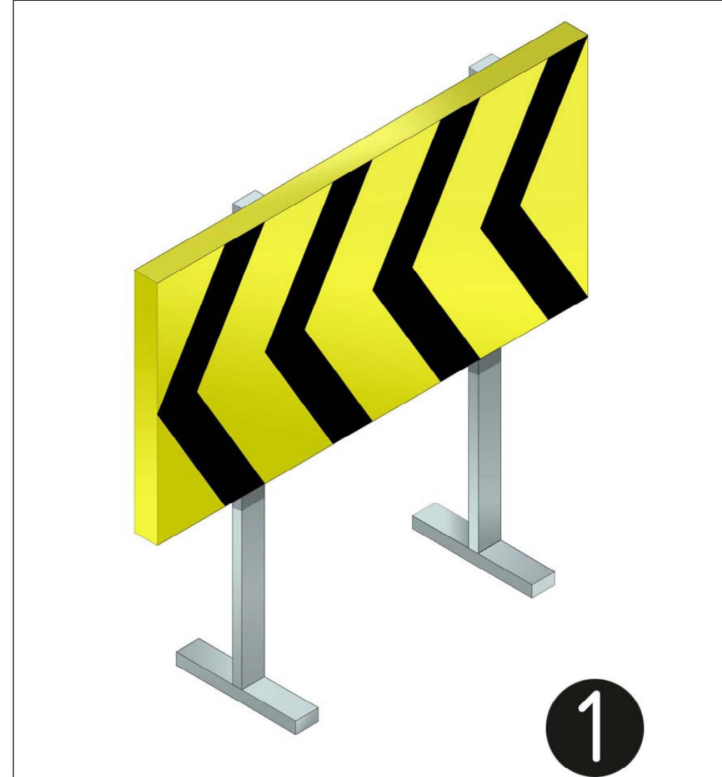
1. plafó desviament de trànsit
