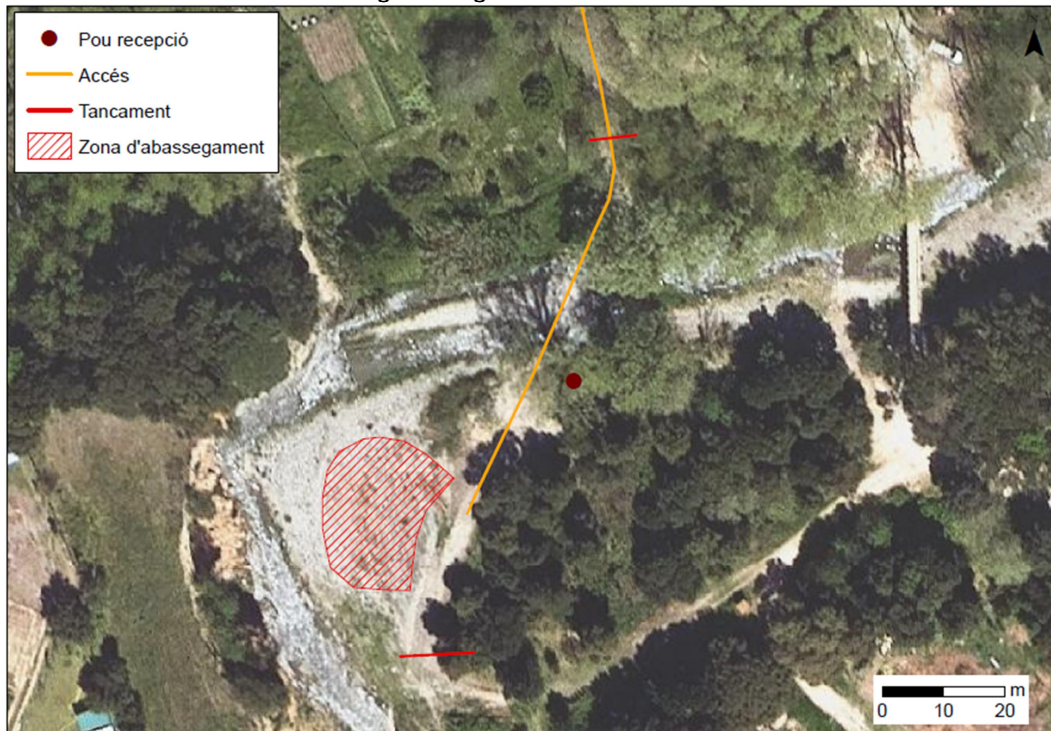
Imatge 1. Organització de les obres
