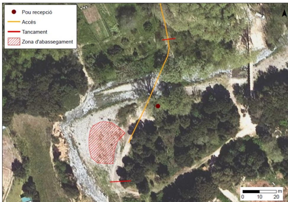
Imatge 23. Organització de l'obra
