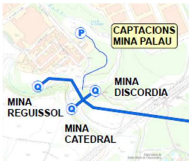
Imatge 8. Esquema de les branques que componen la Mina Palau
