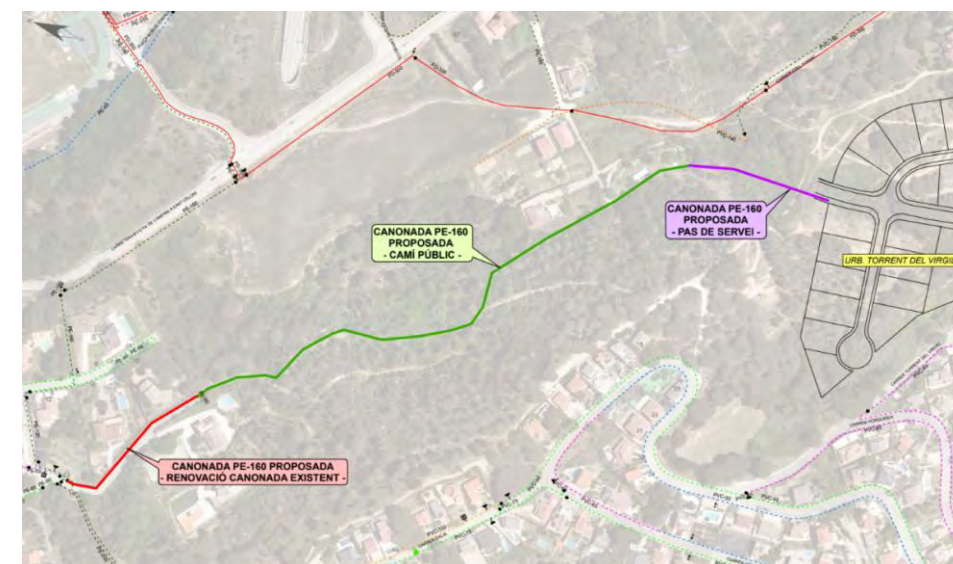
Figura 60- Proposta de subministrament a partir del dipòsit Virgili. Font: Assessorament xarxa d'aigua potable projecte urbanització Sant Celoni
